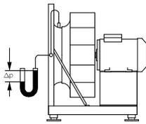
Standardmäßig sind die Ventilatoren mit einer Volumenstrom-Messvorrichtung ausgestattet. Dadurch ist eine einfache Volumenstrombestimmung und –überwachung des Ventilators im Einbauzustand möglich.
